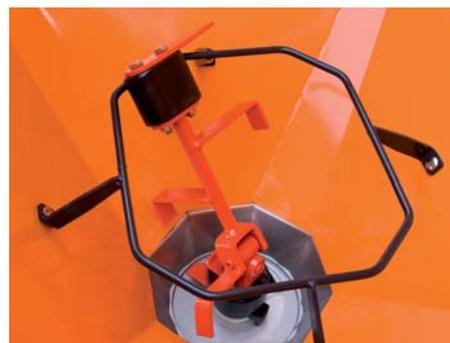
Das Rührwerk rotiert behälterschonend im Anlaufing.
